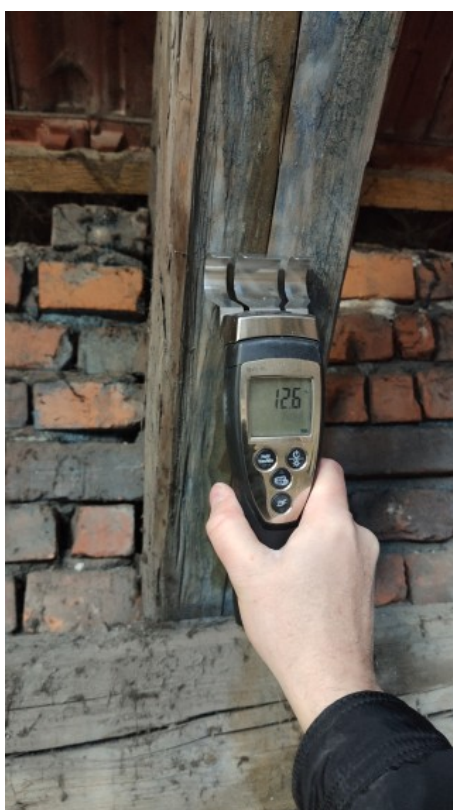
Zdj. 19. W większości drewnianych elementów konstrukcyjnych pod 3-5mm warstwą drewna o zmienionym zabarwieniu na kolor szary kryje się zdrowe jasne drewno o silnej strukturze. Jest to wyraźnie widoczne w miejscach pobrania próbek do badań.
