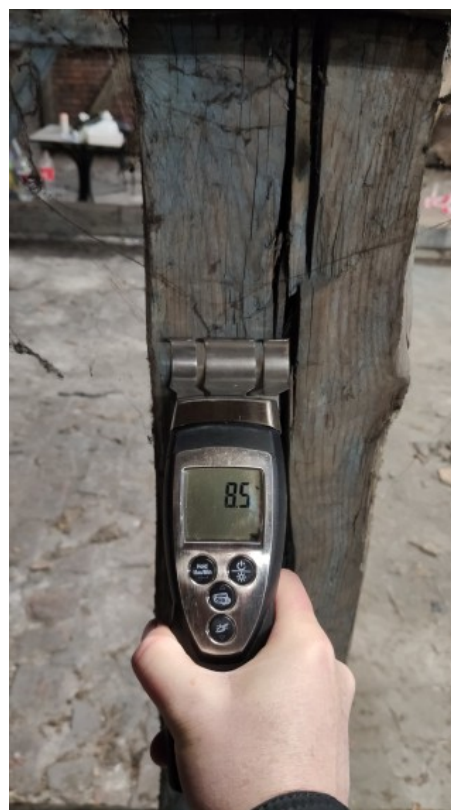
Zdj. 19. W większości drewnianych elementów konstrukcyjnych pod 3-5mm warstwą drewna o zmienionym zabarwieniu na kolor szary kryje się zdrowe jasne drewno o silnej strukturze. Jest to wyraźnie widoczne w miejscach pobrania próbek do badań.
