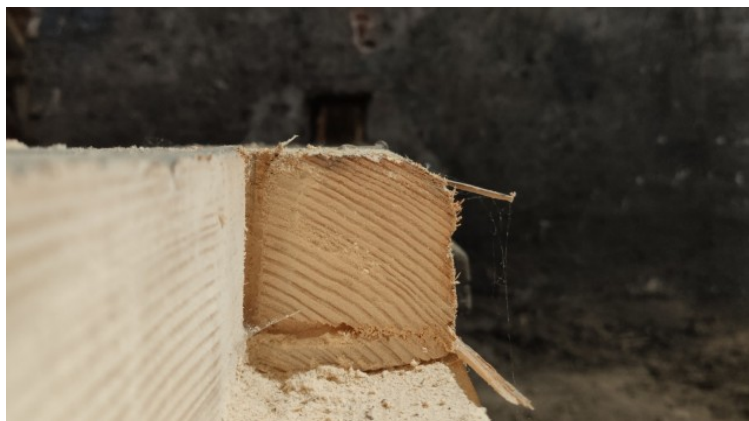
Zdj. 19. W większości drewnianych elementów konstrukcyjnych pod 3-5mm warstwą drewna o zmienionym zabarwieniu na kolor szary kryje się zdrowe jasne drewno o silnej strukturze. Jest to wyraźnie widoczne w miejscach pobrania próbek do badań.
