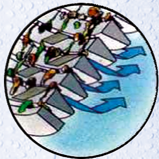
Rys. 1 - zasada działania sita bębnowego
