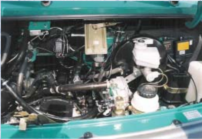
Silnik z zamontowaną instalacją gazową LPG
