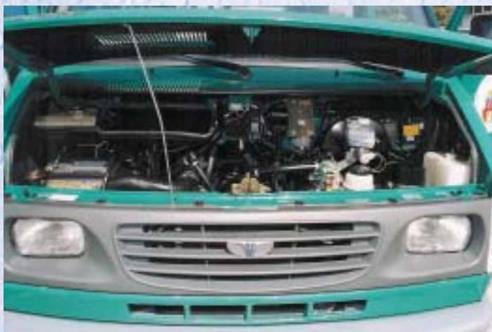
Silnik z zamontowaną instalacją gazową LPG
