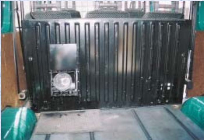
Zbiornik gazu zamontowano w bezpiecznym miejscu - za rzędem siedzeń
