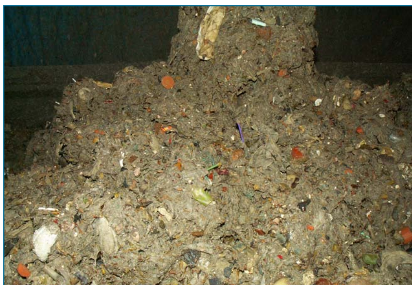
○ Rys 3. Skratki - oczyszczalnia ścieków Kujawy.
