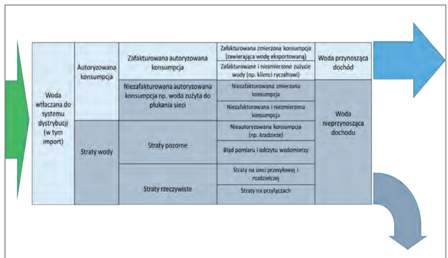
Rys. 1. Bilans wody w systemie zaopatrzenia w wodę według IWA
