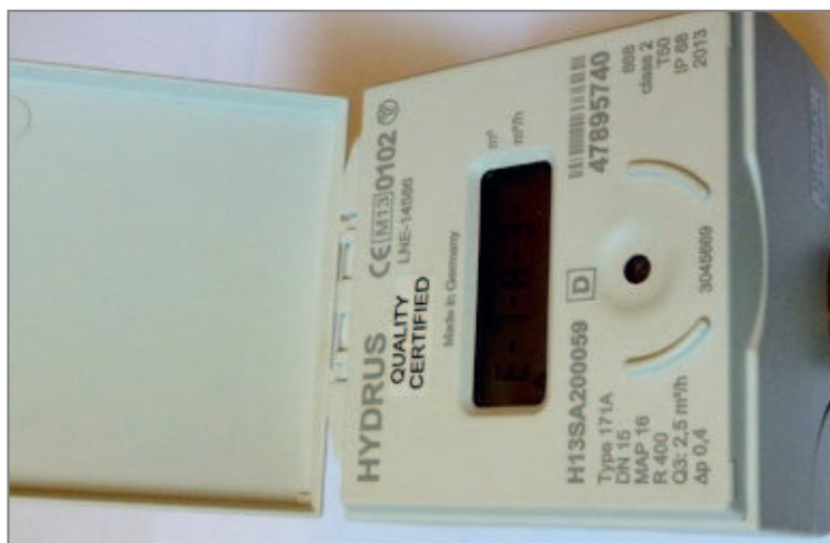
Zdjęcie 3. Widok wodomierza statycznego z ultradźwiękowym układem pomiarowym Firmy Diehl.
