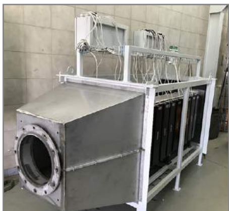
Fot. Widok generatora termoelektrycznego przygotowanego do montażu na ciągu spalin.
